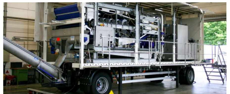
Exakt nach Kundenwunsch designte das Team hierfür eine maßgeschneiderte mobile Siebbandpresse der neuesten Generation, die auch die Anbindung und Steuerung externer mobiler Aggregate mitermöglicht. Mit einem Durchsatz von bis zu 18 m³/h kann sie flexibel und innerhalb kürzester Zeit in Betrieb genommen werden.
